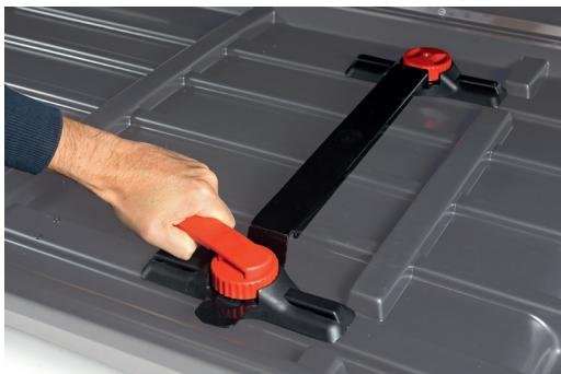
Avvitare il pomello dell'attacco rapido in modo di fissare la staffa portasci al fondo del baule.
